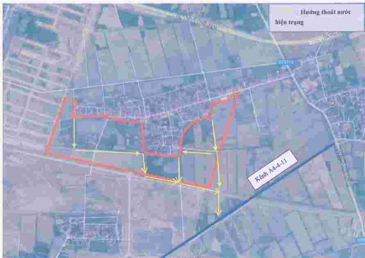
Hình 1. 4. Hiện trạng thoát nước của dự án
